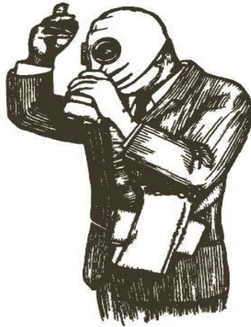
Рисунок 7 – Пример снятия лицевой части (в составе фильтрующего противогаза)
